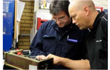
Volvon työkalujen huoltokorjaamolla Ingemar suorittaa vianhaun Power Focus -yksikössä, joka Volvon mukaan "ei tuota 24 V:tä I/O:hon".
